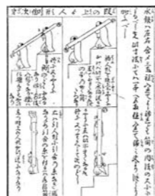
← 「機巧図彙」上巻の最後に紹介されている「連理返り」人形。「五段回り」人形と同じく、水銀の重心移動を利用。水銀の封入された棒を抱えた2体の人形が、回転をしながら階段を降りる。2体の人形には、糸が張ってあり、上に来た人形は宙返りを行う仕掛けとなっている。下の写真は、「五段回り」同様、東野進氏が再現したもの。
