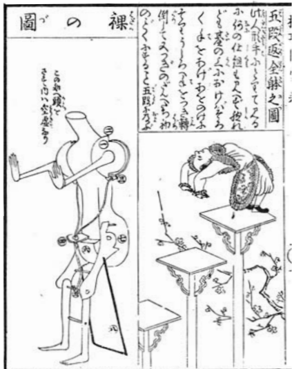
↓ 「機巧図彙」上巻に記載された「五段回り」人形の設計図を基に、科学技術史研究家の東野進氏が再現したもの(左下写真)。人形を段の上に、後ろ向きに立たせると、バック転をしながら段を下っていく。人形の体内に仕込まれた水銀が移動することで自動的に重心移動が起こり、軽やかな動きを見せる。
