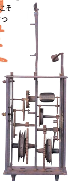
↑ 櫓時計を「機巧図彙」該当ページと比較。全体の構造から歯車の数まで一致が見られる。
