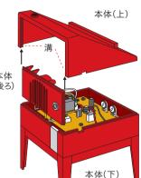
2. ①スイッチレバーを 回路基板上にあるスイッチにかぶせる。 ②本体(上)を本体(下)にはめて ネジ(大)でとめる。
